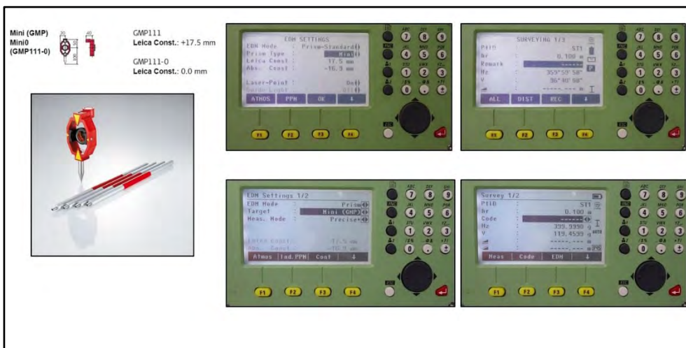
تصویر مربوط به رفلکتور از نوع مینی منشور استاندارد با ارتفاع رفلکتور 0.1 متر
